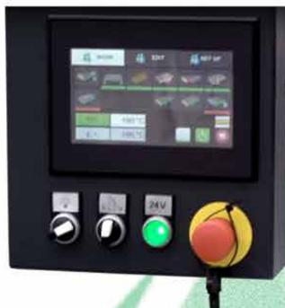
La Akron 1100 está equipada con componentes de alto nivel, electromandriles de HSD, un panel de control con pantalla táctil de 7 pulgadas, depósito extraíble de la cola, estructura rígida y guías lineales.
