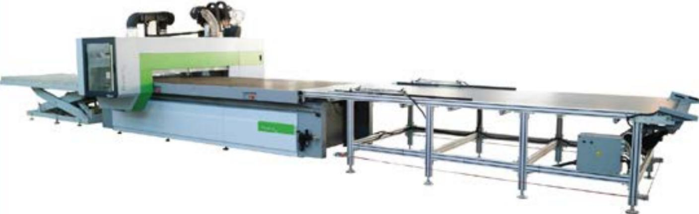
Es el centro de mecanizado de pórtico diseñado para aplicaciones de anidación de madera y materiales a base de madera, pero también a base de plástico y materiales no ferrosos de mecanizado.
